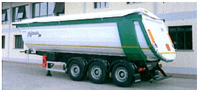
La gamma Cayman dell'azienda trevigiana si è arricchita di nuove casse ribaltabili grazie alle quali la capacità della vasca poligonale arriva fino a 38 metri cubi.
