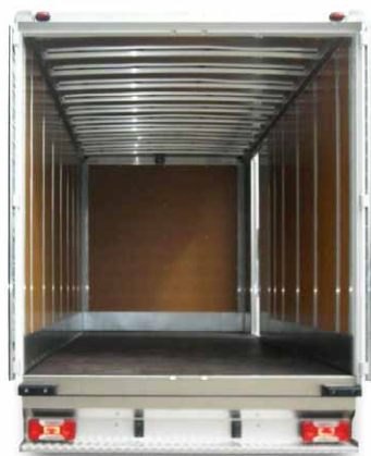
Rivestimento pareti in mogano montato
